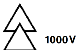
Bildzeichen IEC-60417-5216 (DB:2002-10); geeignet zum Arbeiten unter Spannung; Doppeldreieck und Angabe der Spannung.
